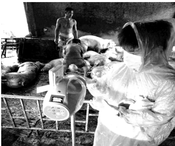
ภาพที่ 1 การเก็บตัวอย่างจุลินทรีย์ในอากาศจากโรงฆ่าสุกร โดย Micro Flow Sampling Head ที่มา : ภาพถ่ายโดยณัฐปติ วิริยวัฒน์และคณะ เมื่อวันที่ 10 เดือน มิถุนายน พ.ศ. 2563
