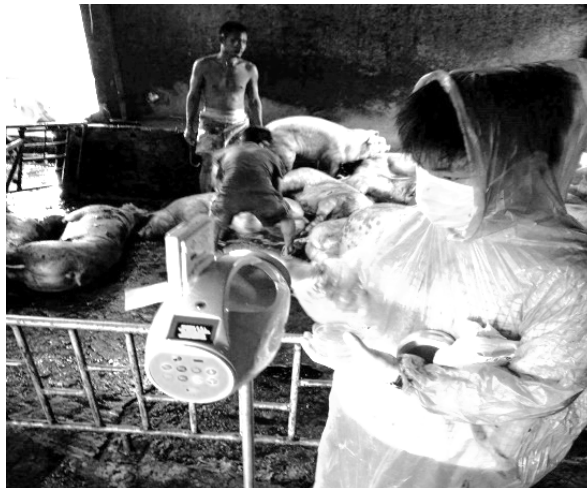
ภาพที่ 1 การเก็บตัวอย่างจุลินทรีย์ในอากาศจากโรงฆ่าสุกร โดย Micro Flow Sampling Head ที่มา : ภาพถ่ายโดยณัฐบดี วิริยวัฒน์และคณะ เมื่อวันที่ 10 เดือน มิถุนายน พ.ศ. 2563
