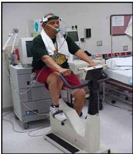
รูปที่ 4 อีกมุมหนึ่งของ Metabolic Room ขณะอาสาสมัครกำลังถูกทดสอบสมรรถภาพในการออกกำลังกายที่เรียกว่า VO2 max โดยเครื่อง Cycle Ergometry ก่อนเข้าสู่ Training Program
