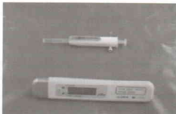
รูปที่ 4 การวาง Pocket dosimeter ทดสอบประสิทธิภาพการป้องกันอันตรายจากรังสี
