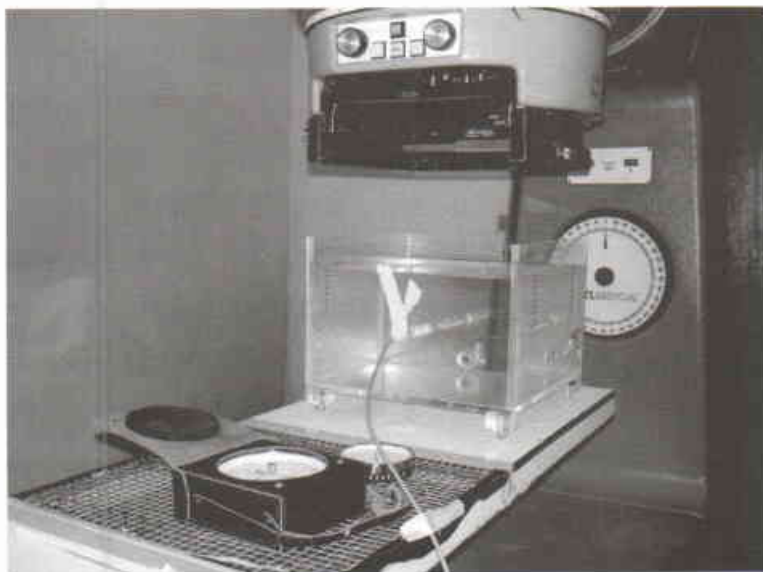
ภาพที่ 1 การจัด water phantom บนเตียงฉายรังสี ให้ศูนย์กลางของหัววัดรังสีอยู่ตรงกับ isocenter ของเครื่องโคบอลต์-60 ทำการวัดอุณหภูมิและความดันอากาศเพื่อแก้ค่าประจจุที่วัดได้โดยหัววัดรังสี
