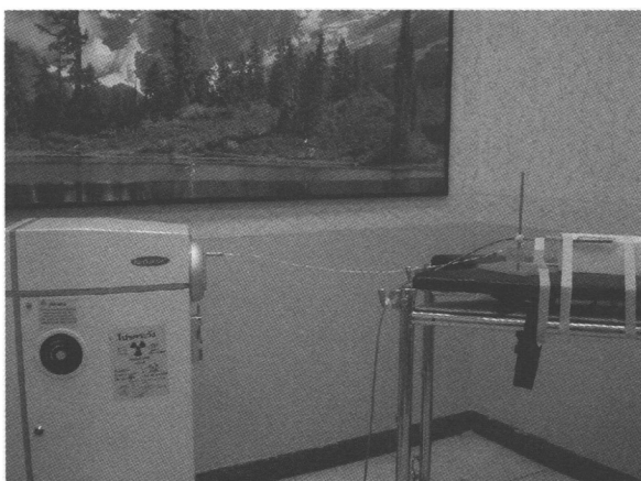
ภาพที่ 3 แสดงการจัดอุปกรณ์ในการฉายรังสีหัววัดรังสีของ ionization chamber ด้วยเครื่องใส่แร่ VariSource รุ่น 200 โดยเอา X-ray marker ออกแล้ววางสายแทนที่ในตำแหน่งเดียวกัน
