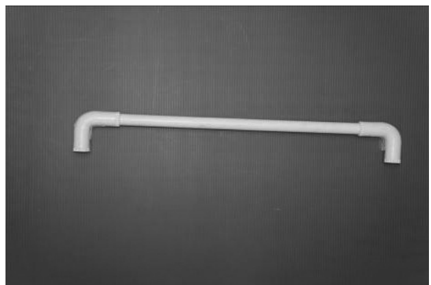
ภาพที่ 2 แสดงท่อ PVC ที่เชื่อมกับข้องอ 90 องศา โดยเชื่อมติดแน่นฝั่งเดียว
