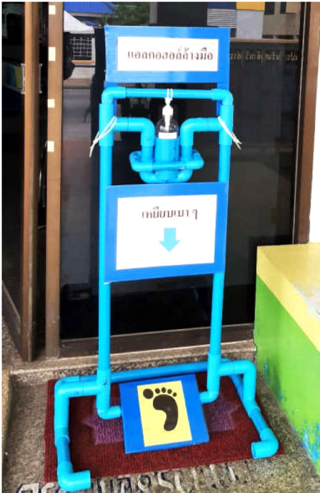
ภาพที่ 7 นวัตกรรมที่กวดเจลแอลกอฮอล์โดยใช้เท้าเหยียบ
